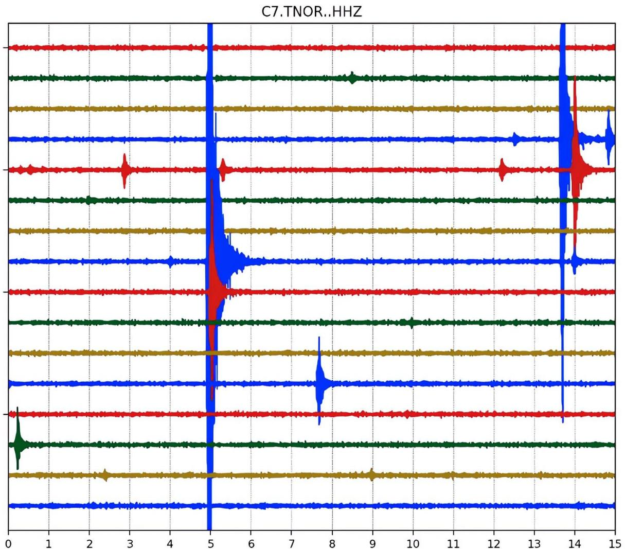
El estudio de la microsismicidad es de interés para diferentes aplicaciones industriales. Primero la monitorización de la sismicidad inducida en sitios de explotación industrial (geotérmica, hídrica, minera) tiene relevancia para la mitigación del posible riesgo sísmico asociado a dicha actividad. De hecho, el seguimiento en tiempo real de la microsismicidad permite interrumpir algunas actividades que puedan dar lugar a eventos sísmicos inducidos de magnitud demasiado alta.
