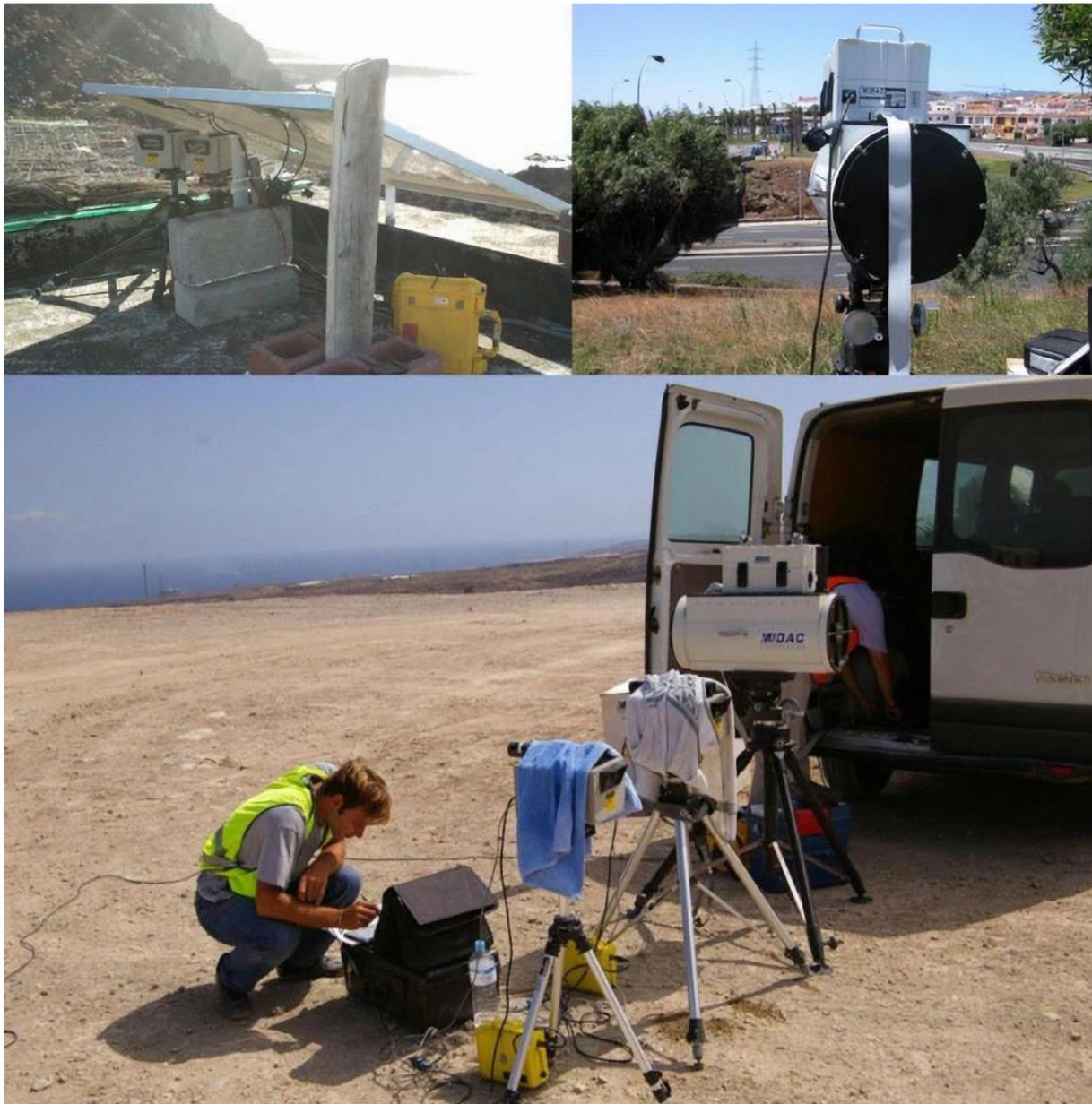
Estos estudios están focalizados en la monitorización de los niveles de concentración, de un contaminante atmosférico ( $H_2S$ ,  $CO_2$ ,  $CH_4$ ,  $NH_3$ ,  $HF$ ,  $HCl$ ,  $SO_2$ ) en lugar, ambiente, deseado. Nuestra experiencia en su uso y estudios ejecutados se centran en aquellas fuentes de origen natural, volcánico. También se han realizado estudios de emisiones de  $CH_4$  y  $NH_3$
