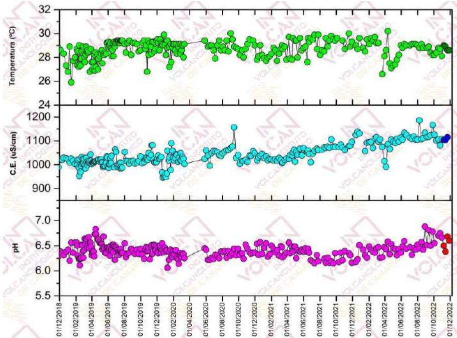
**Figura 4.9** - Variaciones temporales de temperatura, conductividad ( $\mu\text{S}\cdot\text{cm}^{-1}$ ) y pH medidas en el agua subterránea de la estación geoquímica TFG03. Los datos de noviembre de 2022 se encuentran indicados en diferentes colores.
