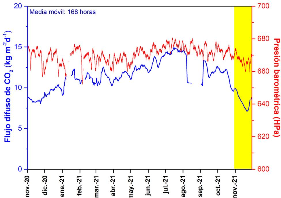
**Figura 4.2** - Monitorización de la media móvil semanal del registro en modo continuo del flujo de  $\text{CO}_2$  (azul) y la presión barométrica (rojo) de la estación geoquímica TFG12 (Mirador de la Fortaleza del Teide, Tenerife). Los datos de noviembre de 2021 se encuentran indicados por el área amarilla.
