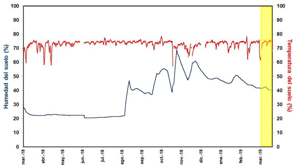
**Figura 2.2** – Variaciones temporales de la media móvil semanal relacionada con el registro en modo continuo de la humedad (azul) y la temperatura (rojo) a 40 centímetros de profundidad en estación termométrica TFT12 (Mirador de la Fortaleza del Teide, Tenerife). Los datos de marzo de 2019 se encuentran indicados por el área amarilla.
