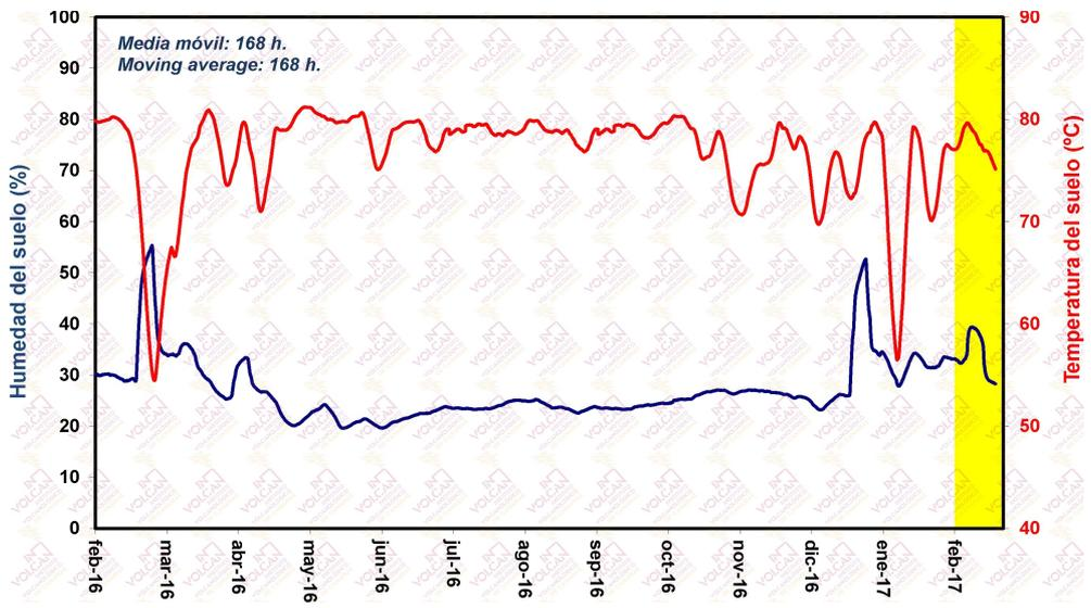
**Figura 2.2** – Variaciones temporales de la media móvil semanal relacionada con el registro en modo continuo de la humedad (azul) y la temperatura (rojo) a 40 centímetros de profundidad en estación termométrica TFT01 (Pico del Teide, Tenerife). Los datos de febrero de 2017 se encuentran indicados por el área amarilla.
