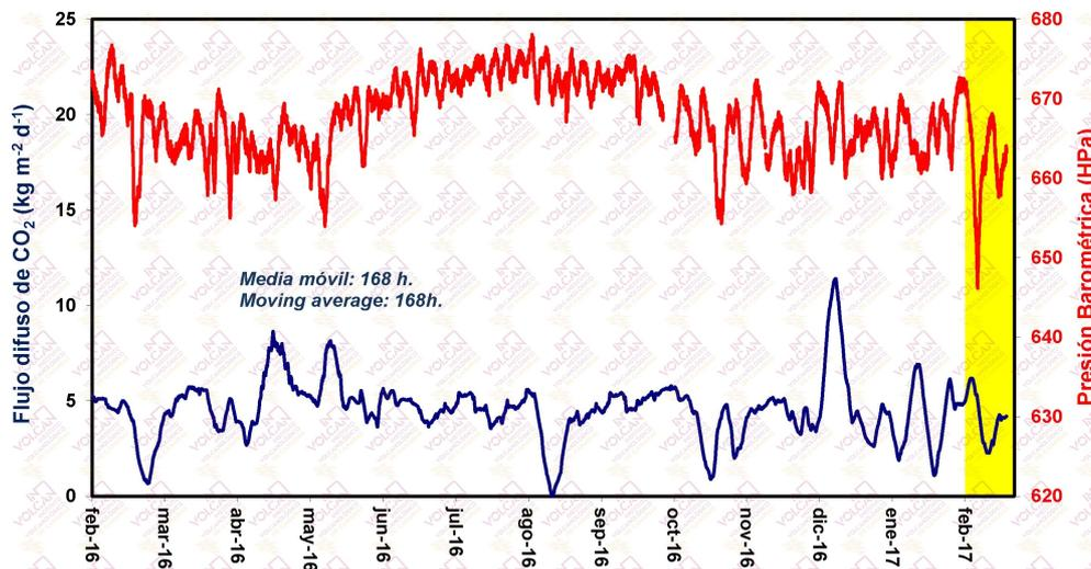
**Figura 4.2** - Monitorización de la media móvil semanal del registro en modo continuo del flujo de  $\text{CO}_2$  (azul) y la presión barométrica (rojo) de la estación geoquímica TFG01 (Pico del Teide, Tenerife). Los datos de febrero 2017 se encuentran indicados por el área amarilla.
